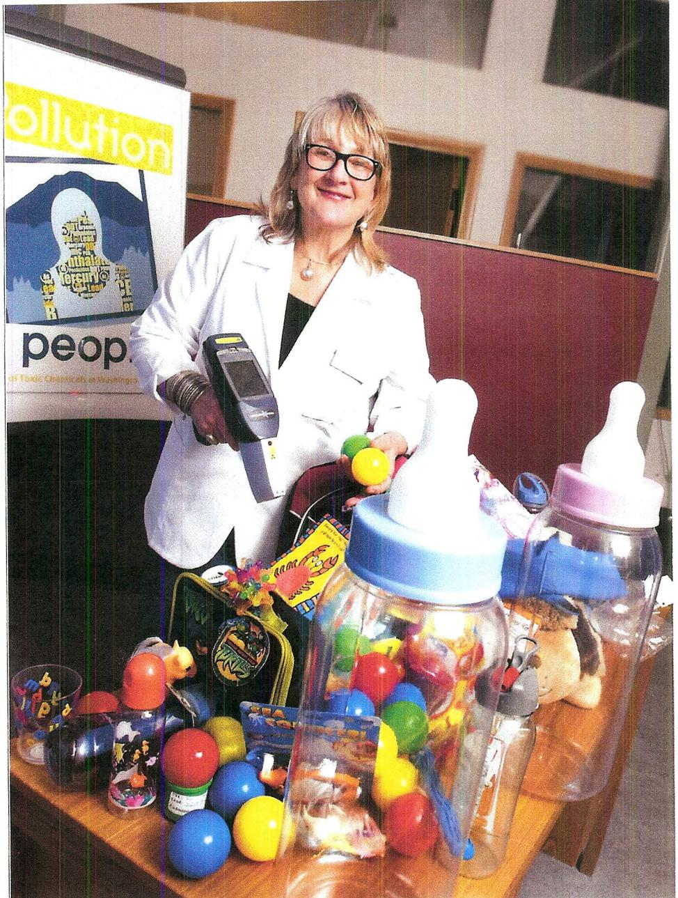
KAREN BOWMAN USES AN X-RAY FLUORESCENCE ANALYZER GUN TO TEST CHILDREN'S TOYS FOR LEAD, ARSENIC, CADMIUM AND OTHER HEAVY METALS.
